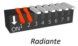
**Modo Aprendizaje/ Operativo:** El DIP8 del SW1 sirve para activar el modo aprendizaje (Dip 8 "OFF") o modo operativo (Dip 8 "ON")
