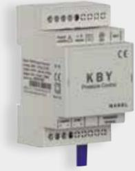
KBY Módulo de control de presión (rango 50-300 Pa). Taraje de la presión mediante selector rotativo. Posibilidad de actuación sobre compuertas motorizadas ZP-AZ/ ZC/ ZR / ZC o bien directamente con una salida 0-10V sobre ventiladores tipo EC. El control KBY dispone de una sonda de presión, un switch de selección y un selector rotativo que permiten fijar fácilmente la presión a mantener.
