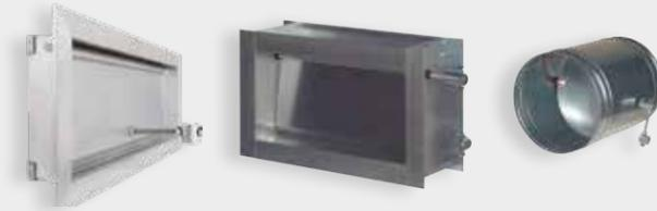
Compuertas de sobrepresión ajustables para Zoning, para el equilibrado de la presión en la red de conductos mediante un contrapeso. Construidas en aluminio y acero galvanizado.
