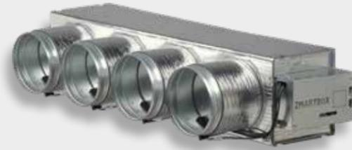
**ZMARTBOX** está formado por un kit de control Zoning, central + termostatos + interface de comunicación (en el caso de unidades de expansión directa) y un plenum repartidor (de 2 a 6 salidas con motor BOSCH + by pass si corresponde) compatible con la mayoría de unidades interiores de climatización conducto de expansión directa o Fan-coil.
