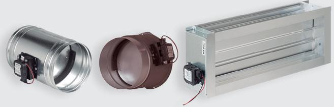
Serranda motorizzata (24 V<sub>DC</sub>) ad alette contrapposte per bocchette di Zoning. Costruita in alluminio e acciaio zincato. Ingranaggi in poliammide e guarnizione in PVC.
