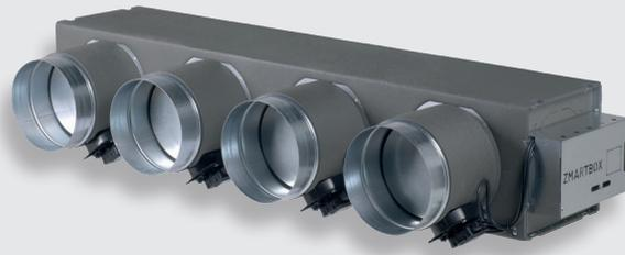
Kit Zoning plug&play. Comprende un plenum macchina isolato e motorizzato PLZON e l'elettronica di controllo (centralina + termostati + interfaccia). Fornito già cablato e configurato pronto per essere installato.
