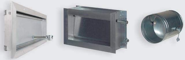
Controllore di pressione costante (da 20 a 300 Pa per impianti Zoning). Controlla serrande motorizzate di bypass (ZP-AZ / ZC / ZR / ZQ) o direttamente i ventilatori EC mediante segnale 0-10 V. La centralina KBY dispone di un sensore di pressione, un interruttore e un selettore girevole che permettono di regolare agevolmente la pressione desiderata.
