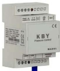
**KBY** Module de contrôle de la pression(plage 50 à 300 Pa). Tare de la pression en tournant un bouton. Action possible sur les moteurs des clapets ZQ et ZR ou directement avec une sortie 0-10V sur les ventilateurs de type EC, pour agir comme By-pass.
