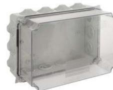
**CIP** Boîtier modulaire isolant IP55 avec rail DIN incorporé. Permet de protéger les panneaux de contrôle contre la poussière et l'humidité dans des atmosphères agressives.
