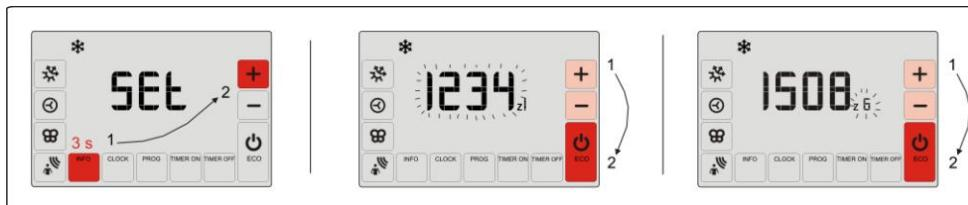
NOTA: La prima volta che si inseriscono le pile si accede direttamente al menu configurazione. Se non si accede direttamente al menu configurazione, o si desidera fare una modifica, entrare in modalità set up (con termostato acceso) mediante la combinazione dei tasti in figura. Di seguito ripetere i passi da 1 a 3 della figura sopra.
