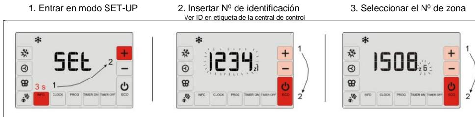
NOTA: La primera vez que se insertan las pilas, se accede directamente al menú de configuración. En el caso de no acceder automáticamente a la configuración o de quererse modificar, se debe entrar en modo SETUP (con el termostato encendido) mediante las combinaciones de teclas que muestran las figuras.
