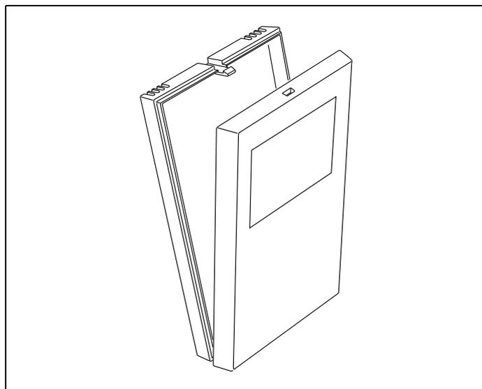
Fig. 2 Cambio de las pilas
