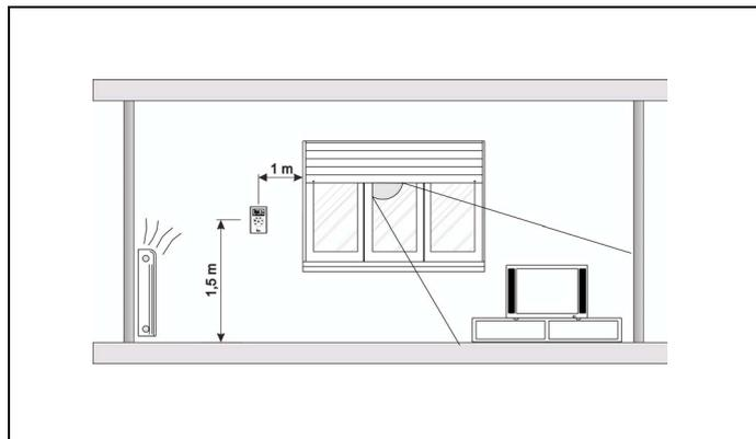
Fig. 1 Emplacement des thermostats
