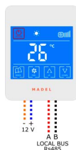
Fig. 16 Schéma de connexion thermostat ZEBRA
