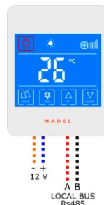
Schéma de connexion thermostat ZEBRA
