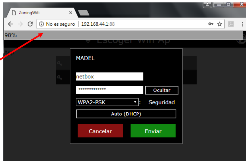
Figura 7: Processo di impostazione Wi-Fi del dispositivo Netbox.
